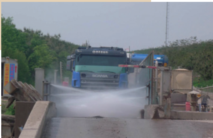
運載垃圾車輛進出填埋場地都進行嚴格的清潔措施
